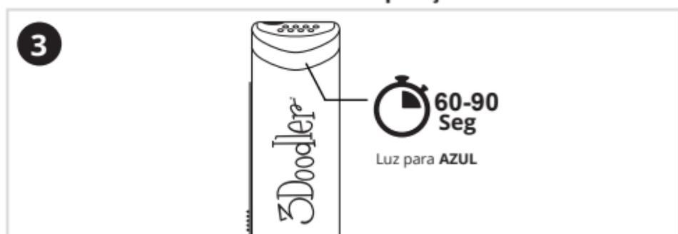
A **luz** vai ficar **VERMELHA** enquanto a **caneta** atinge a temperatura necessária para derreter o **plástico**. Assim que a **luz** fique **AZUL**, a sua **caneta** encontra-se pronta para trabalhar.
