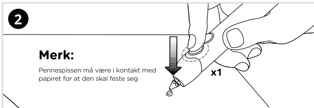
2 Merk: Pennespissen må være i kontakt med papiret for at den skal feste seg. Klikk én gang på en av hastighetsknappene. Når plasten begynner å spraye, trykker du dysen ned på papiret for å få plasten til å feste seg til overflaten.
